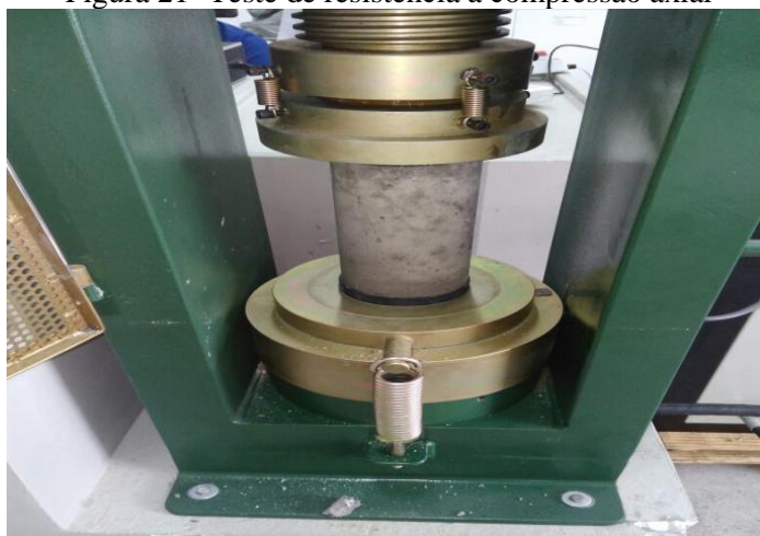
Figura 21- Teste de resistência a compressão axial
