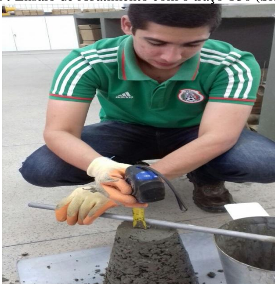
Figura 19: Ensaio de Abatimento com o traço T50 (Slump Test)
