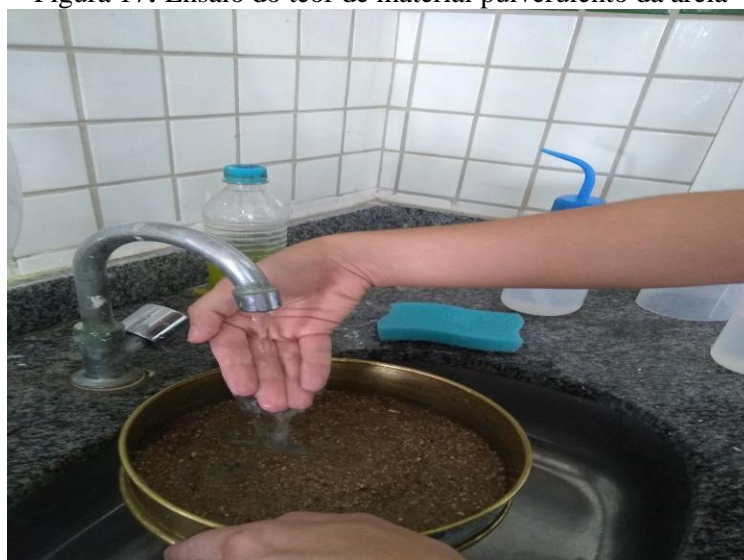
Figura 17: Ensaio do teor de material pulverulento da areia
