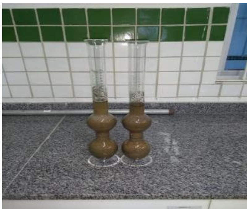
Figura 8: Massa específica do pó de pedra
