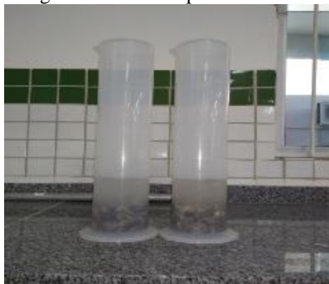
Figura 11- Massa específica da brita
