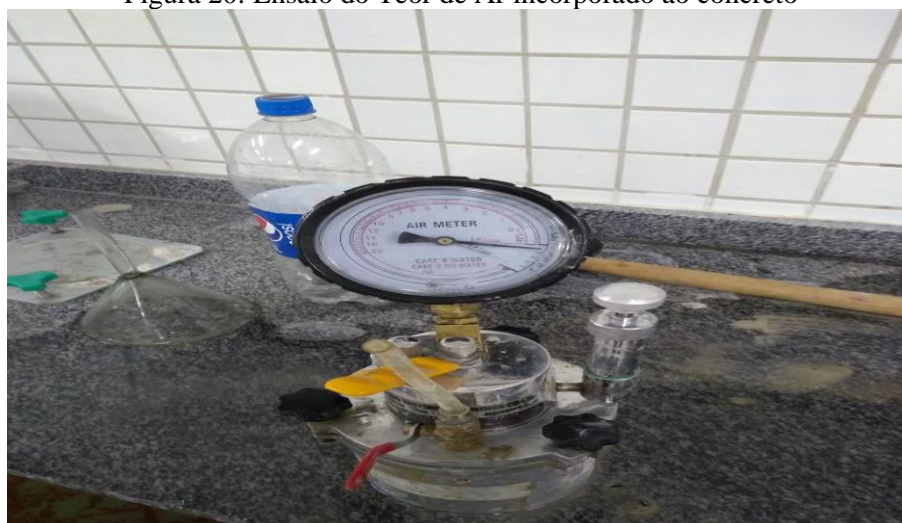
Figura 20: Ensaio do Teor de Ar incorporado ao concreto
