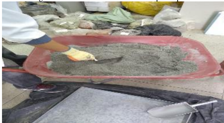
Figura 13: Ensaio de inchamento do pó de pedra.
