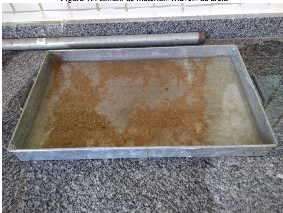
Figura 15: Ensaio de materiais friáveis da areia
