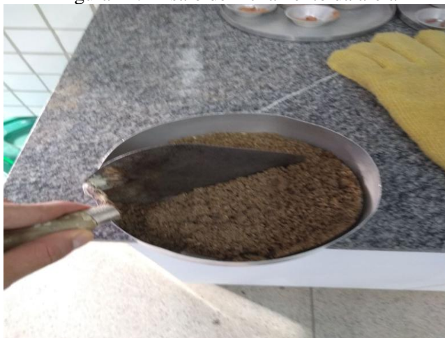
Figura 14: Ensaio de inchamento da areia
