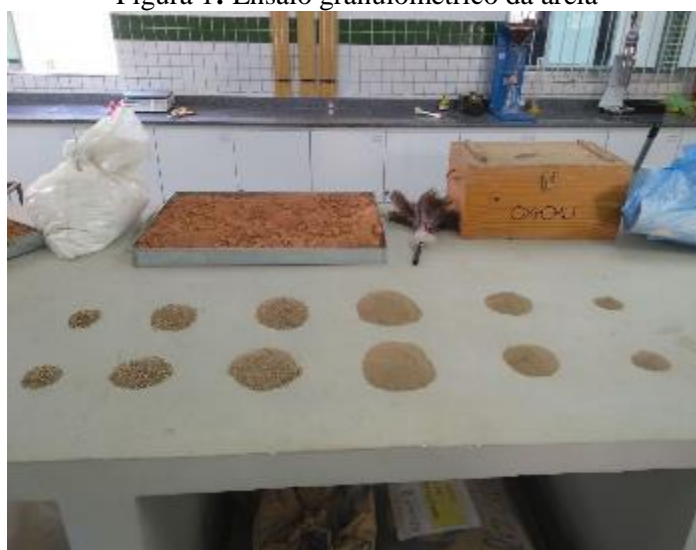
Figura 1: Ensaio granulométrico da areia
