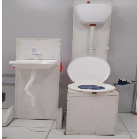
Imagem I: Protótipo de pia e sanitário para eventos de uso racional de água
