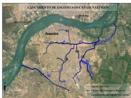
Figura 8 - Pontos de lançamento de esgoto nos canais naturais da drenagem urbana na cidade de Juazeiro-BA, imagem Google Maps (2013).
