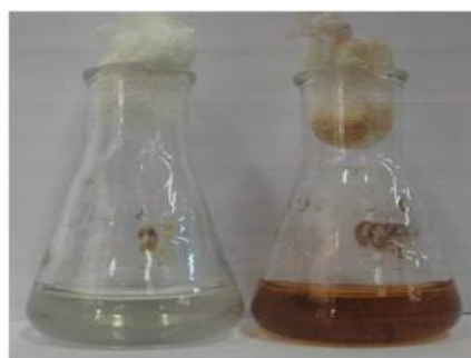
Figura 3 – Ilustração da atuação da enzima nitrato-redutase antes e depois da reação com nitrato de prata e formação de nanopartículas.
