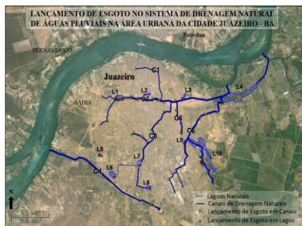
Figura 20 - Pontos de lançamento de esgoto nos canais e lagoas naturais da drenagem urbana na cidade de Juazeiro-BA, imagem do Google Maps (2013).
