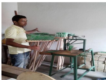
Figura 8: Confecção de vassouras a partir de garrafas PET durante a visita técnica do Colégio Estadual Rui Barbosa de Juazeiro-BA à ONG Ecovale em Petrolina-PE (Fonte: PEV)
